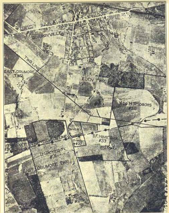
Mapa fotográfico aéreo en el que aparece marcado el proyecto de una línea de transmisión de energía eléctrica de alto voltaje
