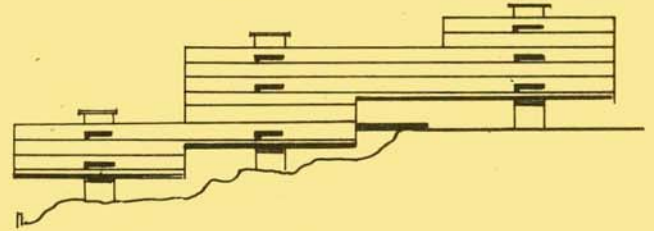
Combinación de elementos mono y binucleares, para la solución en terrenos accidentados (patentes S.C.S.) Vista lateral.
