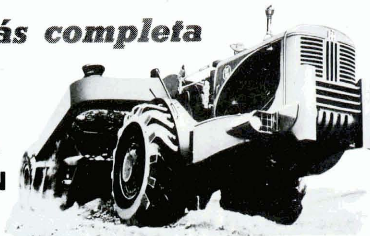
Potente Moto-traílla International "75" transportando fácilmente enormes cargas de tierra hasta de 15.3 m 3 . (20 yd 3 .)
